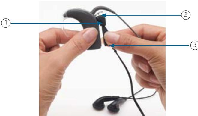
Abbildung 2: Anschließen der Kontrollkopfhörer
